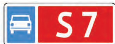
Rys. 6.3.7.8. Znak E-15d z miniaturą znaku D-7
